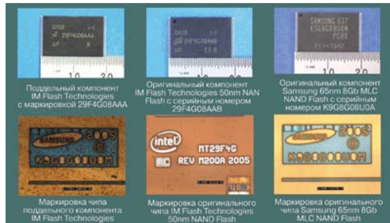
Рис. 2. Слева изображен поддельный компонент с маркировкой IM Flash, но с чипом от Samsung внутри. В центре можно увидеть оригинальный компонент от IM Flash с правильными маркировками. Справа — компонент от Samsung, который использовали для подделки
