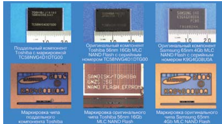
Рис. 1. Слева изображен поддельный компонент с маркировкой Toshiba, но с чипом от Samsung внутри. В центре можно увидеть оригинальный компонент от Toshiba с правильными маркировками. Справа — компонент от Samsung, который использовали для подделки
