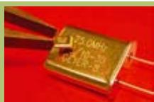
Большинство современных микроконтроллеров и цифровых процессоров уже содержат встроенную схему автогенератора — остается только подключить внешний кварцевый резонатор. Однако для многих приложений удобнее использовать именно кварцевый генератор. В этом случае устройство получается компактнее и надежнее, а разработчику остается только правильно выбрать подходящий генератор. Расчет, изготовление и настройка собственной схемы кварцевого генератора для частот
