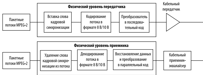
Рис. 1. Схема транспортировки потока DVB-ASI через шину SDI
