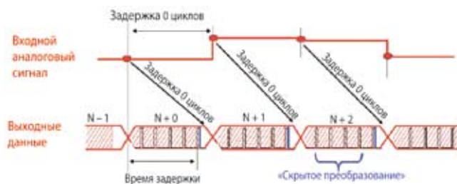
Рис. 5. Выходные данные дельта-сигма АЦП, которые представляют собой комбинацию всех пяти внутренних цифровых прореживающих фильтров. Этот преобразователь имеет задержку ноль циклов
