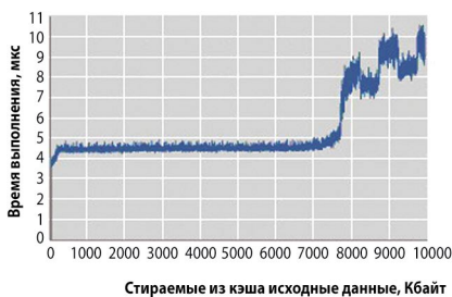
Рис. 3. Время выполнения цикла заданной длительности в зависимости от объема кэшированного кода
