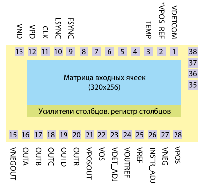
Рис. 3. Цоколевка при работе в командном режиме
