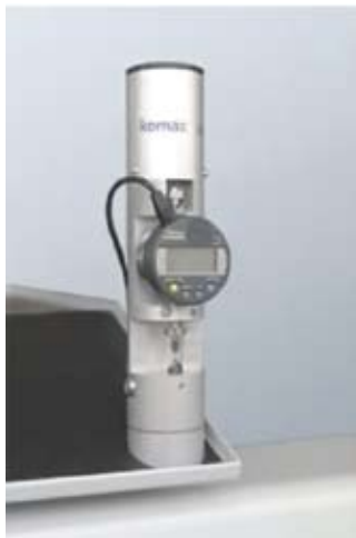
Рис. 3. Интегрированный в машины Komax микрометр для определения высоты опрессовки контакта
