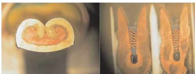
Рис. 9. Распил соединений, выполненных по технологиям «холодного обжима» (слева) и «IDC» (справа)
