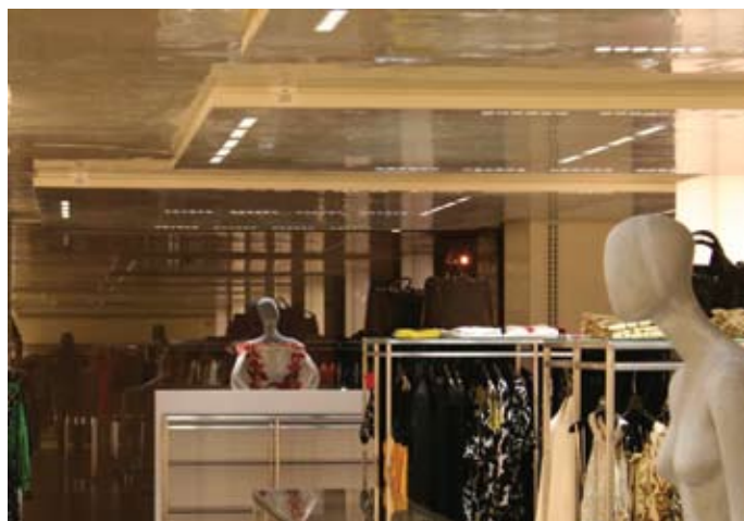
Рис. 15. Уровень освещенности составил 600 лк на горизонтальной поверхности и 1000...1400 лк на вертикальных площадях
