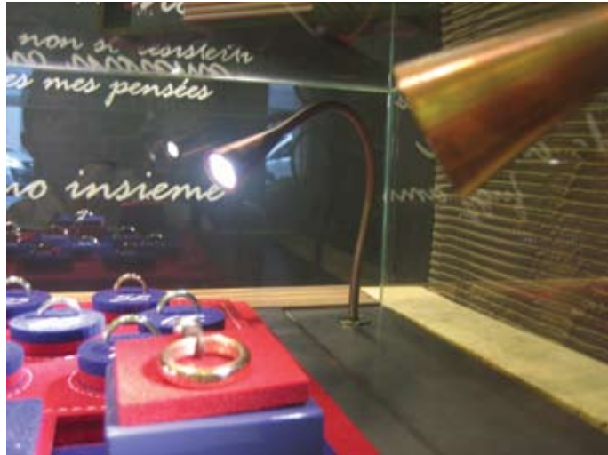
Рис. 8. Одно из преимуществ светодиодов — изначально узкая направленность светового потока
