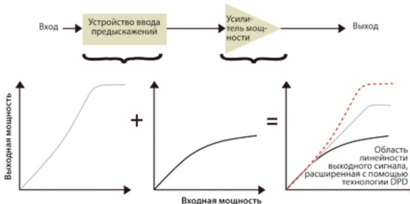
Рис. 3. Предыскажение расширяет линейный диапазон усилителя мощности, компенсируя нелинейность его характеристики
