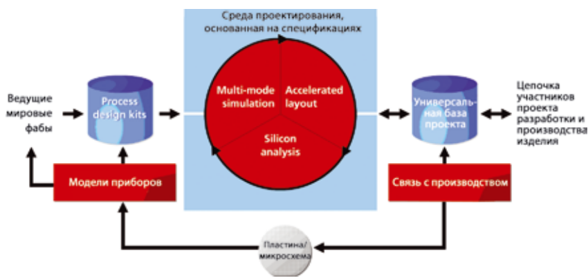
Рис. 3. Платформа схемотехнического и физико-топологического проектирования
