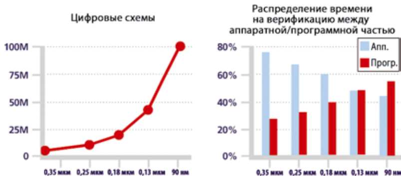
Рис. 6. Временные затраты на верификацию аппаратной и программной части проекта
