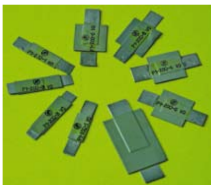
Рис. 4. Самовосстанавливающиеся предохранители ФГУП НИИЭМП
