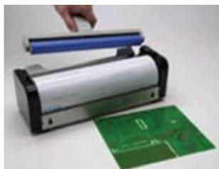
Установка очистки поверхности — Surface Mount Clean Machine компании Teknek предназначена для удаления с поверхности печатных плат пыли и мелких загрязнений.
