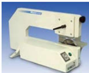
Установка предназначена для разделения заготовок печатных плат, может работать как в автоматическом, так и ручном режимах, имеет две скорости протяжки, может разрезать платы любой длины, как «пустые», так и собранные.
