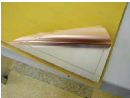
Рис. 3. Образец материала типа САС, применяемого для формирования наружных слоев МПП в пакете прессуемых плат
