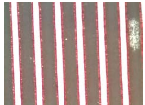
Рис. 5. Прецизионный рисунок: линия/зазор — 80/80 мкм на фольге толщиной 35 мкм
