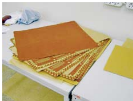
Рис. 4. Комплект слоев для структуры с ламинатом на наружных слоях. Адгезив на первом слое
