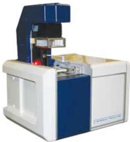
Рис. 2. Тестер контроля паяемости Menisco ST88
