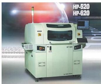
Принтер трафаретной печати HP-620 компании SJ Inno Tech с рабочей зоной 736 × 736 или 800 × 800 мм наносит пасту с точностью ±0,015 мм.
