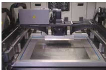
Рис. 5. Управление перемещением ракеля на основе ШВП
