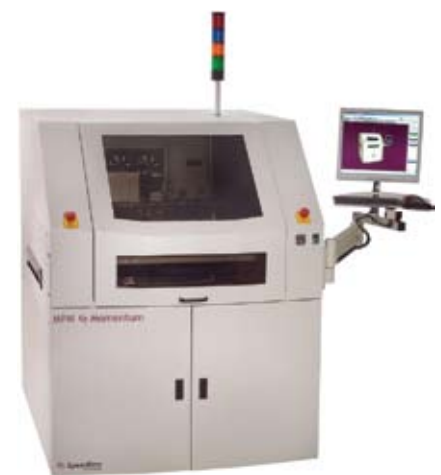
Рис. 2. Автоматический принтер трафаретной печати MPM Momentum от Speedline Technologies
