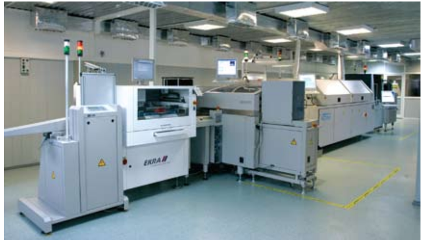
Рис. 2. Линия автоматического поверхностного монтажа компании «ЭлеСи»
