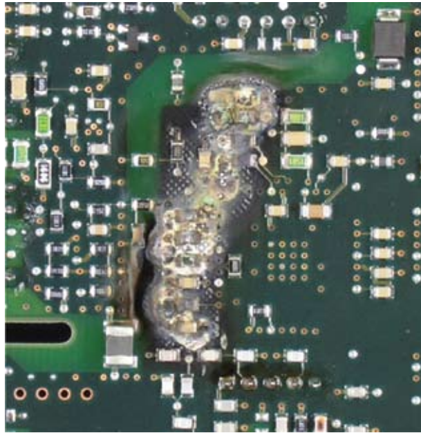
Рис. 1. Искрение и обугливание платы, вызванное электрохимической миграцией
