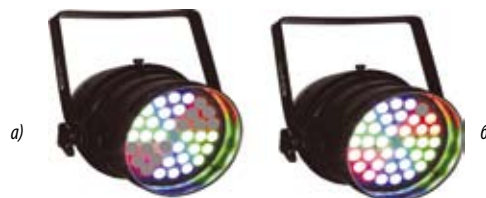
Рис. 1. Сравнение того, как проявляется единичный отказ в кластерных светодиодных прожекторах: а) обычная схема из трех параллельных цепочек по 12 светодиодам (шунтирование каждого светодиода не используется); б) используется активное шунтирование каждого светодиода в цепочках
