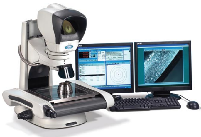
Рис. 3. Система бесконтактных измерений Hawk, построенная на персональном компьютере с программным обеспечением QC5000
