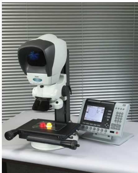
Рис. 2. Система бесконтактных измерений Kestrel, построенная на видеопроцессоре QC200
