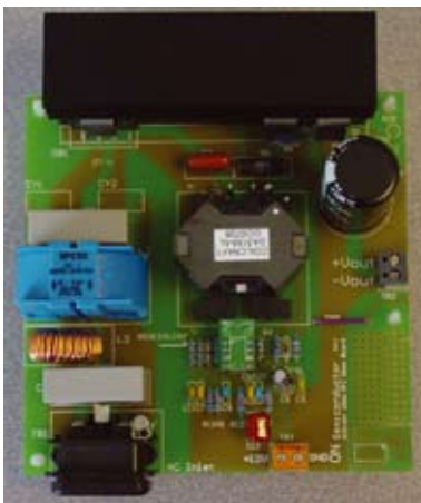
Рис. 5. Конструкция платы корректора коэффициента мощности на 300 Вт
