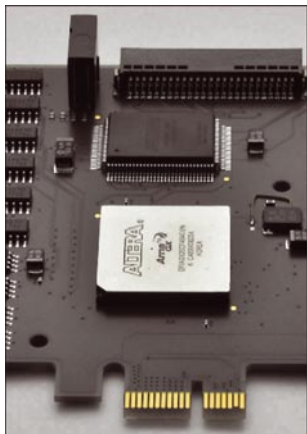
рис. 3. Плата оцифровки видеоизображения на основе FPGA
