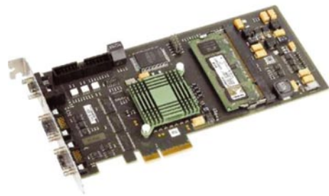
рис. 1. Устройство захвата изображения PC_EYE/CL стандарта PCI Express использует весь потенциал интерфейса Camera Link
