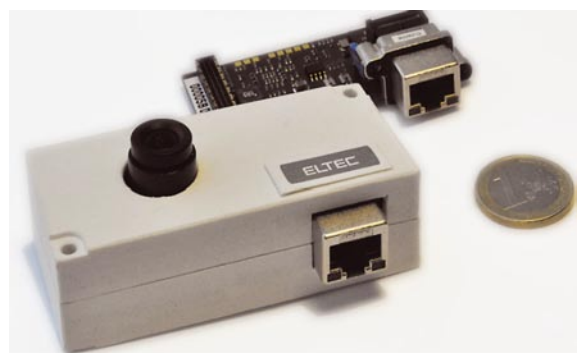
рис. 2. Модуль камеры с интерфейсом GigE Vision
