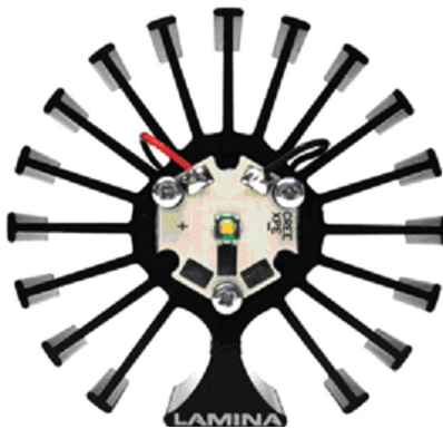
Рис. 15. Демонстрационная плата NCL30100
