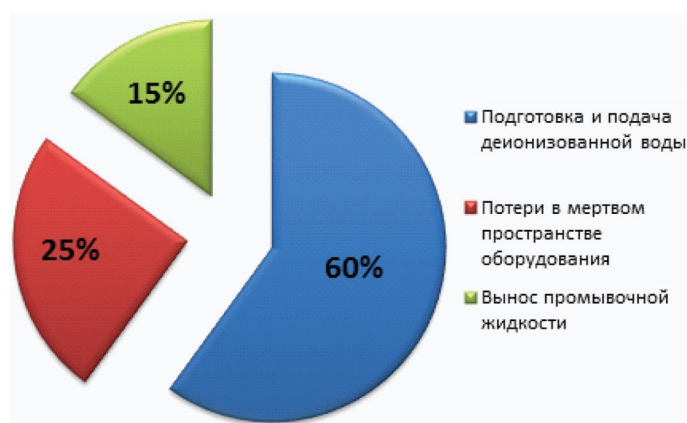
Рис. 4. Доли затрат в типичном процессе отмычки при использовании технологии MPC
