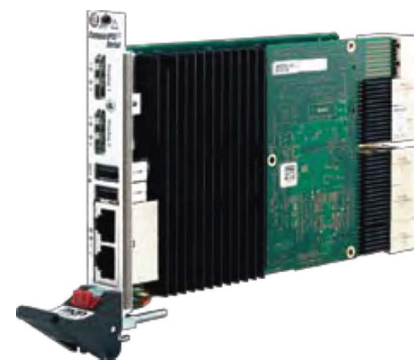
Рис. 3. G20 — первая SBC MEN, в основе которой лежит стандарт PICMG CPCI-S.0 CompactPCI Serial. На ней установлен 64-разрядный процессор i7 с частотой работы 2,53...3,20 ГГц
