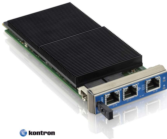
Рис. 1. Модуль Kontron AM4120 формата AdvancedMC, выполненный на базе современного PowerPC-процессора Freescale QorIQ P2020 для рынка коммуникаций
