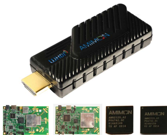
Рис. 2. Представители второго поколения WHDI-модулей (вверху: WHDI-стик, который обеспечивает просмотр содержимого планшета и ноутбука на телевизор; внизу: модули передатчика и приемника беспроводного видеомодема WHDI)
