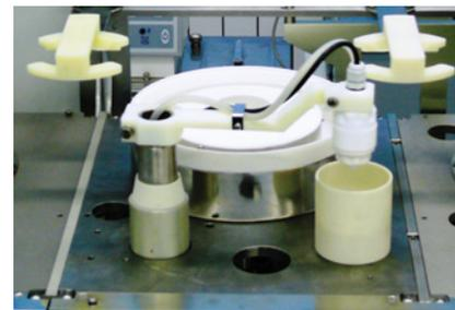
Рис. 6. Устройство МО: 1 — пневмоцилиндр; 2 — платформа; 3 — центрифуга; 4 — ванна; 5 — отражатель; 6 — столики; 7 — стакан; 8 — МЗ форсунка; 9 — планка; 10 — механизм перемещения
