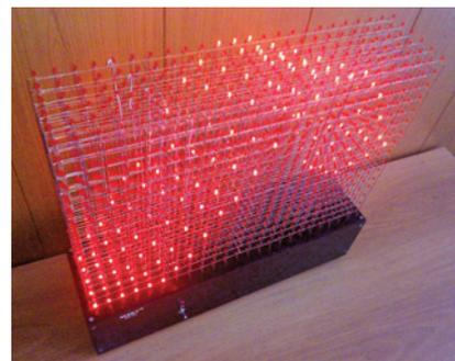
Рис. 4. Устройство отображения трехмерной информации с интерактивными возможностями
