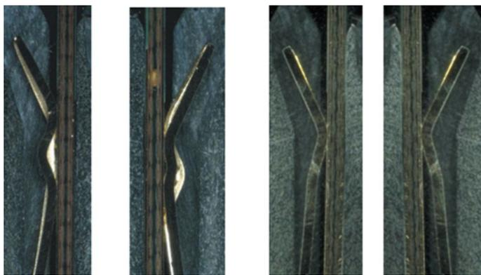
Рис. 4. Четырехкратное резервирование контактных групп
