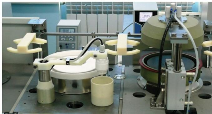
Рис. 5. Модуль — МЗ/ГМДС: 1 — устройство мезазвуковой обработки пластин; 2 — устройство термообработки в парах ГМДС; 3 — каркас; 4 — вставка; 5 — поддон с вытяжным коллектором; 6 — МЗ генератор; 7 — блок подачи деионизованной воды
