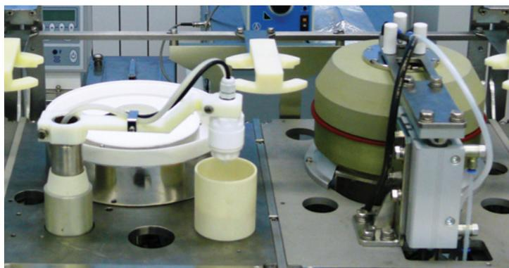
(над стаканом) осуществляется механизм перемещения 10. Положение инструмента в рабочем или в исходном положении контролируется датчиком. Кроме того, планка с МЗ форсункой 8 может производить сканирование над пластиной. Контроль сканирования осуществляется датчиком.
