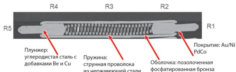
Рис. 1. Внутренняя структура пружинного зонда. Детали цепи формирования сопротивления и используемые в конструкции материалы
