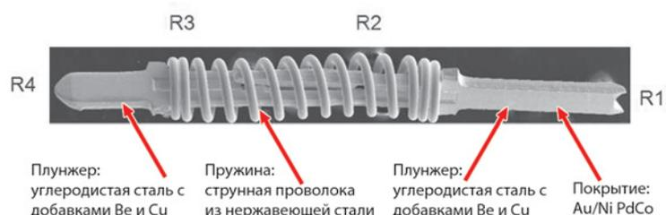
Рис. 2. Внутренняя структура зонда со штампованными плунжерами. Детали цепи формирования сопротивления и используемые в конструкции материалы
