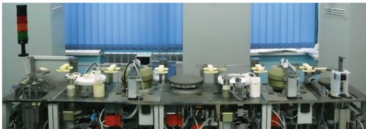
Рис. 2. Агрегат формирования фоторезистивных плёнок: 1 — сигнальная колонна; 2 — модуль загрузки; 3 — модуль мегазвуковой обработки и термообработки в парах ГМДС; 4 — транспортная система; 5 — модуль термостабилизации и нанесения фоторезиста; 6 — модуль термообработки и приёма пластин
