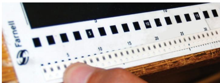
Рис. 1. Специализированная линейка для подсчёта компонентов
